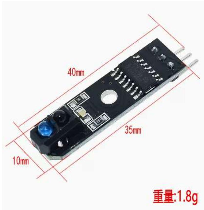
由于黑色具有较强的吸收能力，当循迹模块发射的红外线照射到黑线时，红外线将会被黑线吸收，导致循迹模块上光敏三极管处于关闭状态，此时模块上一个LED熄灭。在没有检测到黑线时，模块上两个LED亮。
