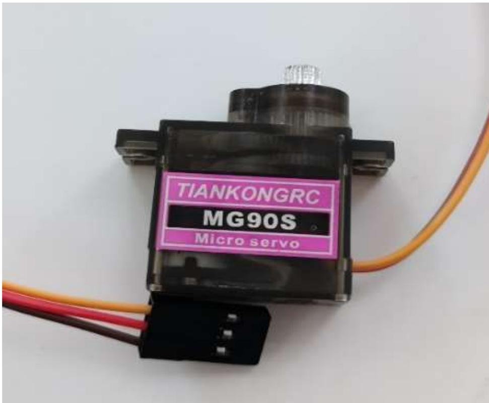
舵机的引线，一般为三线控制（没有接触过不是三线的），红色为电源，棕色为地，黄色为信号。控制舵机的时候，需要不断的给 PWM 波才能使得舵机在某个角度有扭矩。
